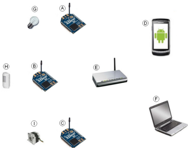
Figura 12–Comunicação através de roteador Wi-Fi.
